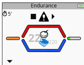
На пульте дистанционного управления отображается символ электрода и отключенного модуля, а также мигает стрелка, указывающая на соответствующий канал (в данном случае канал 1).
