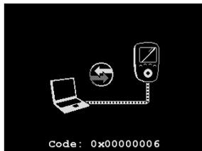
Если процедура синхронизации была прервана или не может быть успешно выполнена по каким-либо причинам (отсоединен пульт дистанционного управления, отсутствует питание и т. д.), на пульте дистанционного управления отображается следующий экран.
