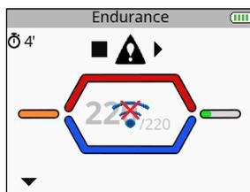
На пульте дистанционного управления отображается символ модуля вне зоны действия, а также мигает стрелка, указывающая на соответствующий канал (в данном случае канал 1).
