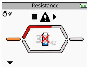
Во время стимуляции модуль может разрядиться. В этом случае отображается символ разряженной батареи, а также мигает стрелка, указывающая на соответствующий канал (в данном случае канал 1).
